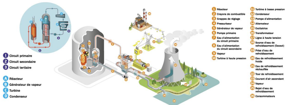
Figure 8 : Fonctionnement schématisé d'une centrale nucléaire
